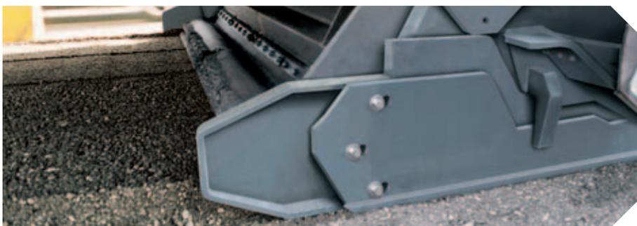
Rapprochée du rotor, la barre de concassage broie les gros blocs de manière fiable
