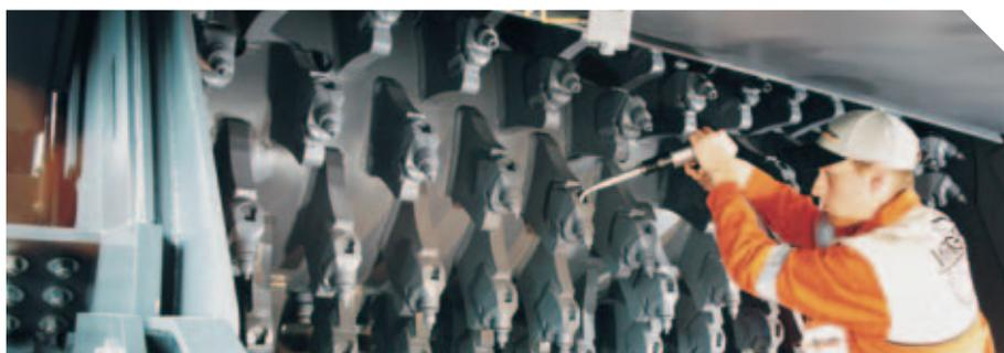
Le chasse-pics pneumatique (en option) se raccorde à l'installation à air comprimé (8 bars) fournie en série et démonte les pics en toute rapidité et facilité.
