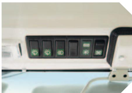
▲ Touches de commande du chauffage des vitres et de la climatisation (en option)
