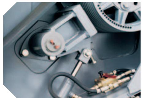
Tendeur de courroie automatique : ▲ pour une transmission optimale des forces
